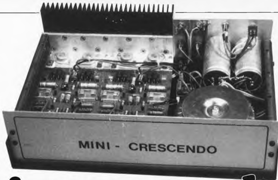
Figure 5. Vue plongeante dans les entrailles du mini-crescendo construit dans un boîtier de faible hauteur. Pour des raisons techniques (matériel d'exposition), la lampe de visualisation de mise sous tension et l'interrupteur marche/arrêt se trouvent à l'arrière de l'appareil.
