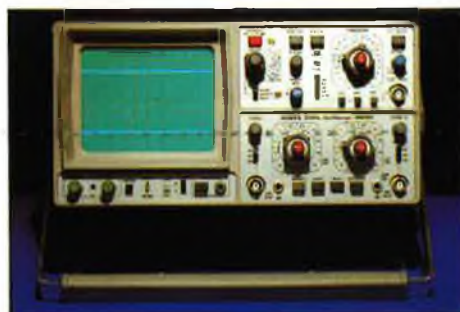
HM 204 - 2 x 20 MHz testeur de composants avec sondes combinées 5270 F.
