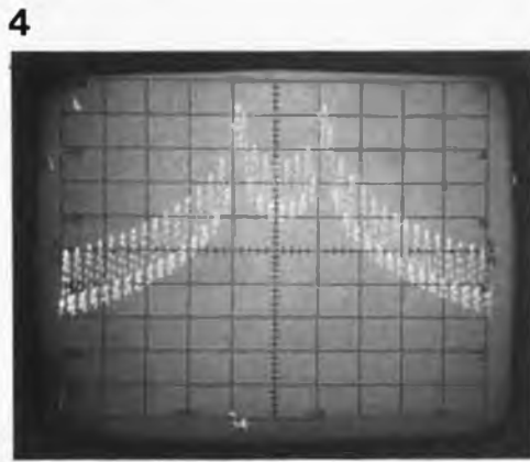
Figure 4. Un signal FSK peut être considéré comme la combinaison de deux fréquences voisines alternées en tout ou rien.
