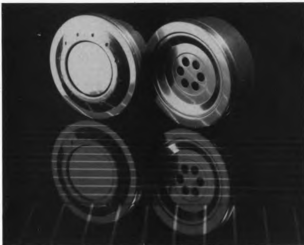
Photo. 2 capsules extraites d'un vieux combiné téléphonique. La capsule de gauche est celle de l'écouteur, celle de droite provient bien évidemment du micro.
