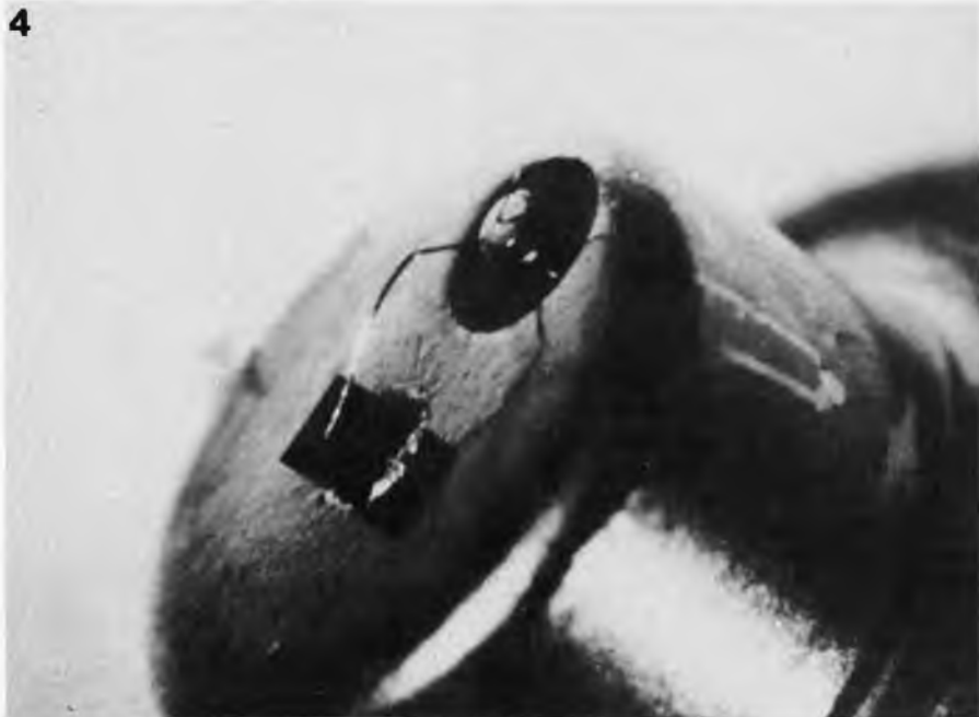
Photo 4. Puce de LED montée dans un boîtier de type TO-18. Le contact -n du centre de la puce est soudé, le contact de la partie -p se faisant par le collage de la puce.
