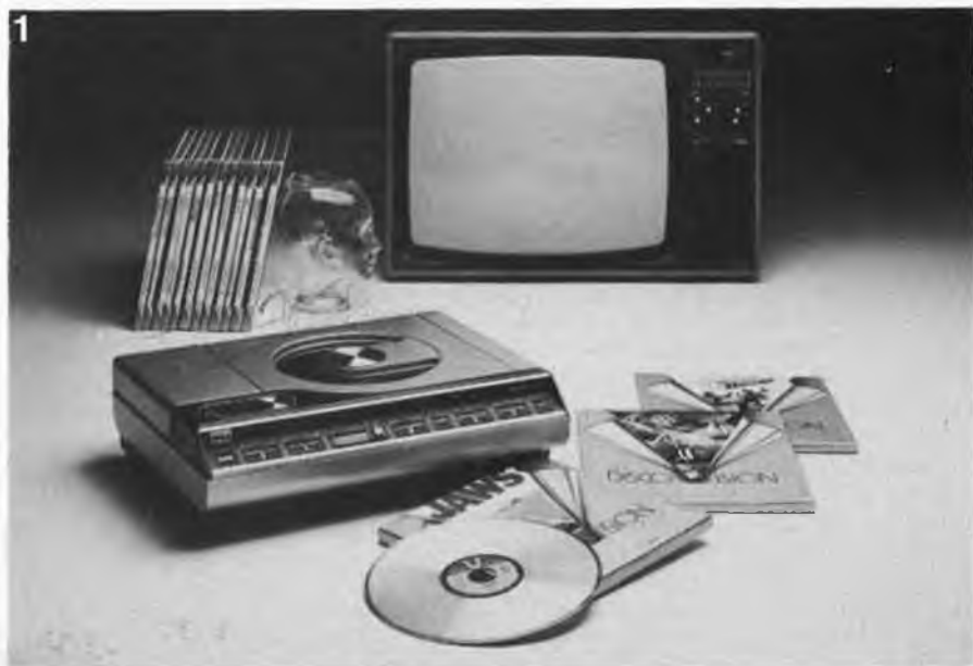
Photo 1. Voici l'ensemble du système LaserVision. Un faisceau laser lit un disque en matière plastique de 30 cm de diamètre. La couche réfléchissante qui contient les informations est protégée par deux couches de protection transparentes. La durée "d'écoute" maximale est de 1 heure par face.
