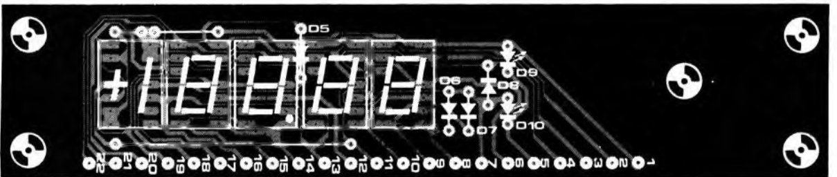
Figure 5. Le circuit imprimé est composé de deux parties: la circuit principal (80021-1) et le circuit d'affichage (80021-2).
