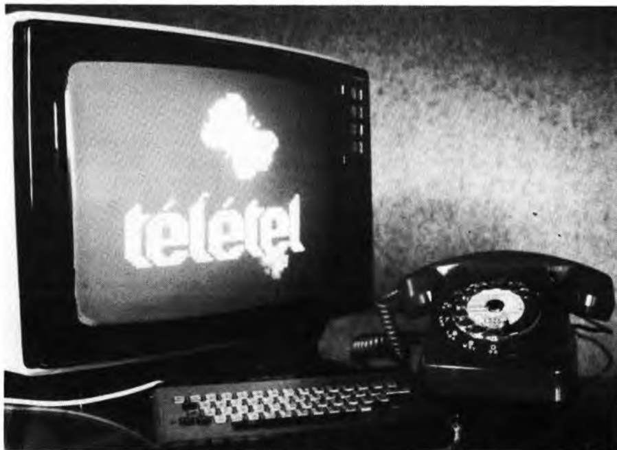
Le système Télétel est interactif. Par l'intermédiaire du clavier et d'une ligne téléphonique, il est possible de converser avec l'ordinateur. (doc SCORE)
