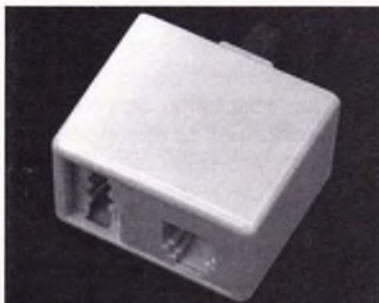
Adaptateur téléphone fax/modem allemand.
