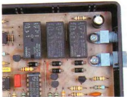
Photo 4. – La fibre optique se connecte par vissage sur les socles montés à cet effet.
