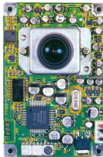
Photo 2 - Caméra miniature CCD noir et blanc.
