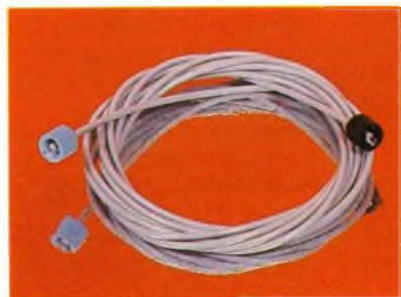
Photo 5. – On remarque ici la fibre optique avec ses deux connecteurs mâles.
