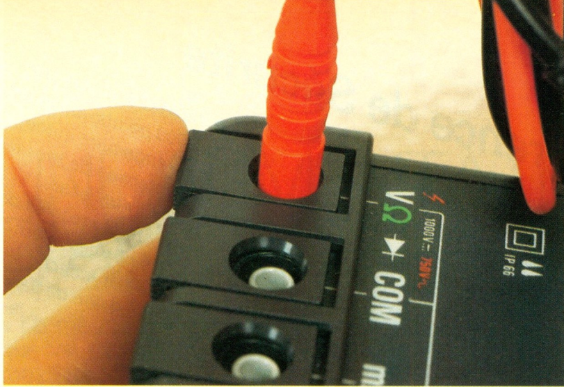
Photo 2. – Aperçu des bornes de connexions utilisant le système « SECUR'X » breveté.
