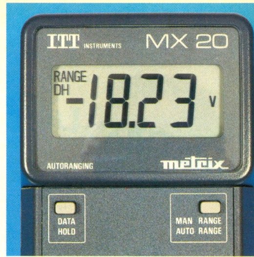
Photo 3. – L'affichage LCD utilise des segments de 17 mm.
