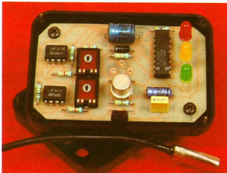
Photo 2. - Les trois LED indiquent les fenêtres dans lesquelles la température se situe.
