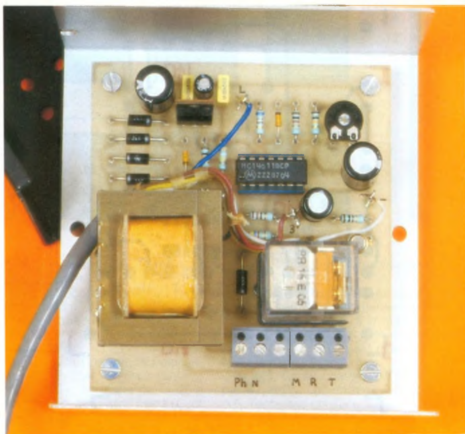
Photo 2. - Le transformateur, au premier plan, abaisse la tension du réseau à 12 V.
