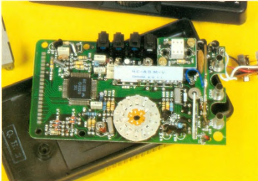
Photo 2. – Le Rotacteur, au premier plan, assure la sélection des calibres et des fonctions.
