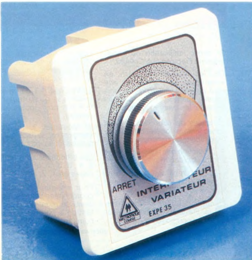
Photo 2. - L'ensemble pourra se fixer sur un support mural de marque « Legrand ».
