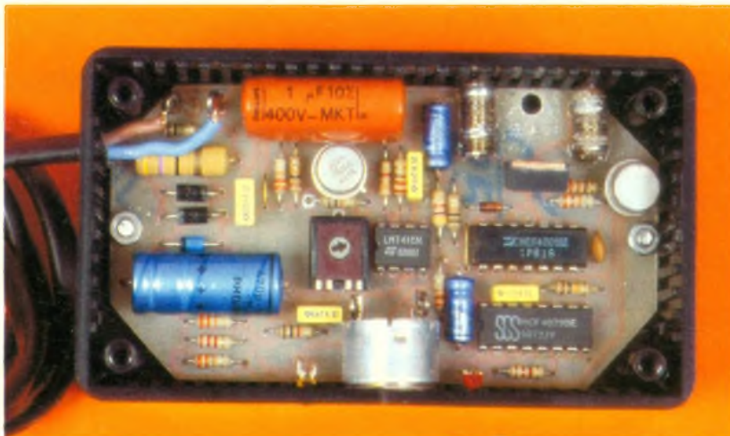
Photo 3. – La platine déposée au fond du boîtier sera soulevée par des vis et des écrous
