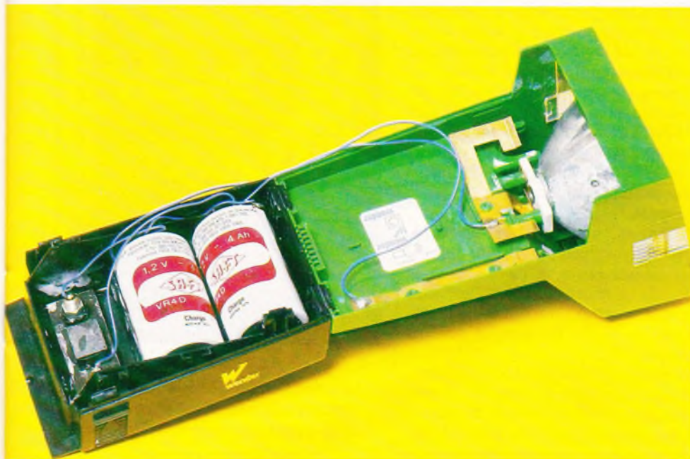
Photo 3. – Le boîtier renferme les deux accus 1,2 V/4 Ah.
