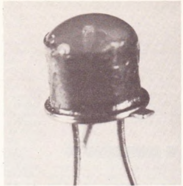
Photo 3. – Un photo-transistor « maison » : un BC 109 décalotté plus une goutte de silicone pour le protéger.
