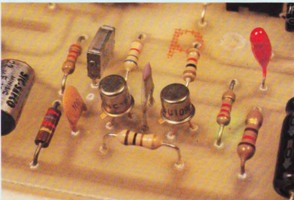
Photo 3. – Le préampli micro, en câblage compact.
