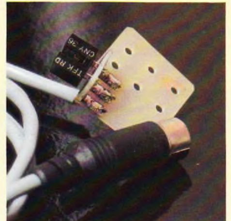
Photo 4. – Le détecteur à fenêtre sur son circuit imprimé.
