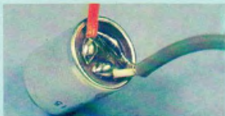
Photo 4. - Gros plan sur le micro électret et ses liaisons.
