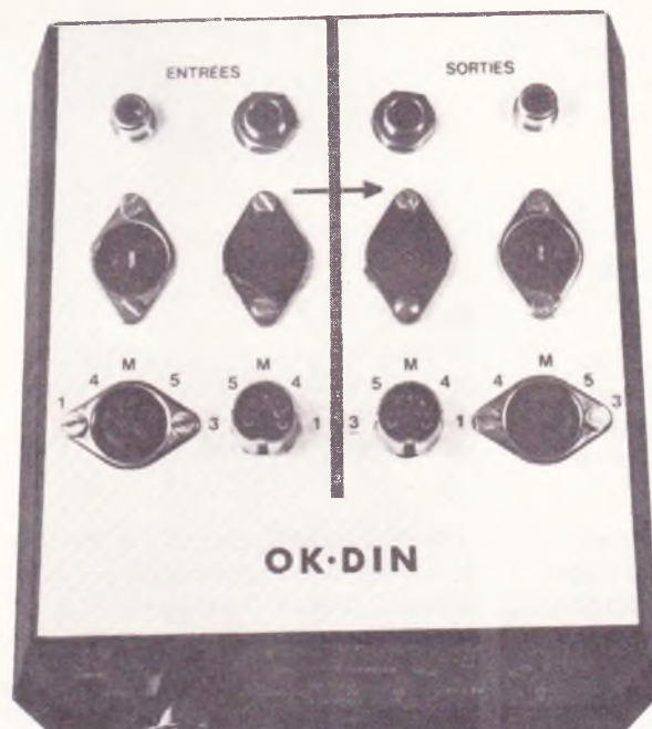
Photo 3. — La platine d'enfichage reçoit des socles CINCH, Jack 6,35 stéréo, HP-DIN mâles et femelles et DIN 5 broches mâles et femelles.
