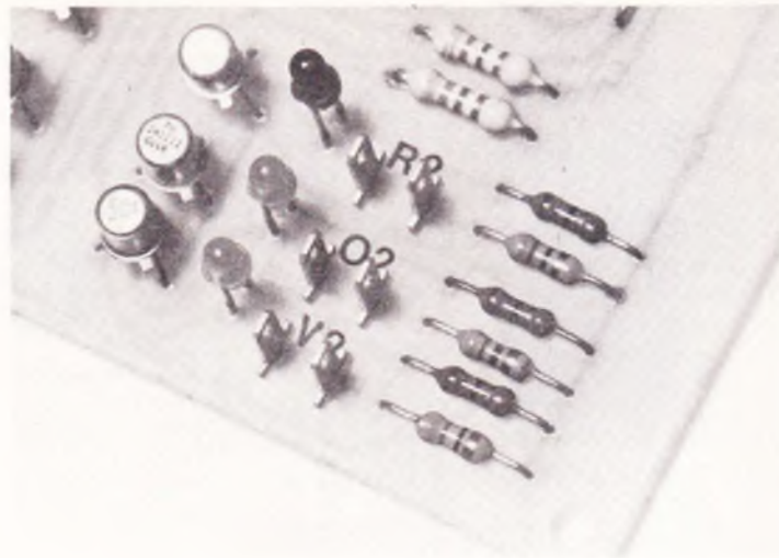
Photo 3. - On pourra, le cas échéant, doubler le nombre de diodes électroluminescentes..
