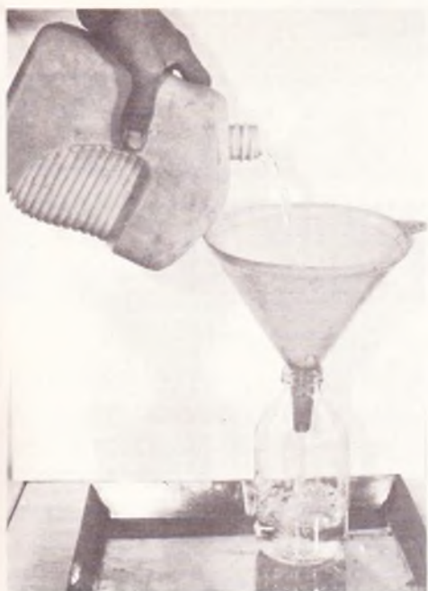
Photo 8. – Pour un versage sans à-coups, un bidon doit être tenu avec l'ouverture en haut et non en bas.
