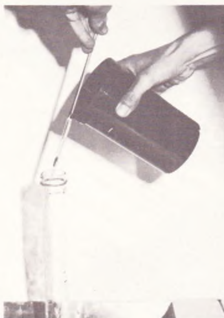
Photo 9. – Une tige appliquée sur le bord du récipient à col large guide le jet de liquide, sans dégoulinades.
