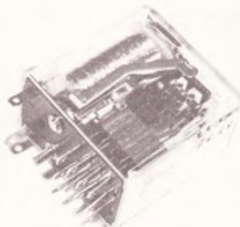
Photo 1. – Le relais type « Européen » est robuste et avec un brochage normalisé.
