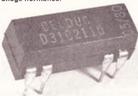
Photo 2. – Dans ce boîtier DIL, un relais REED 1 RT avec diode incorporée. Vitesse 1 ms.
