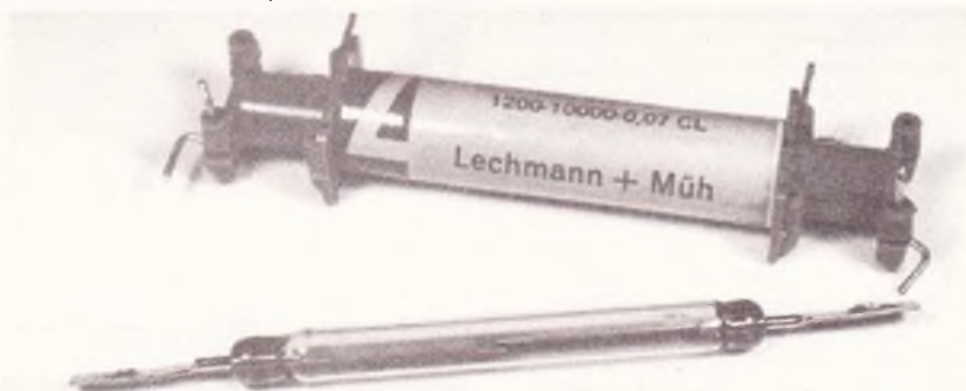
Photo 3. – Une ampoule ILS 1 T. Un champ magnétique extérieur fera coller les deux lamelles souples.
