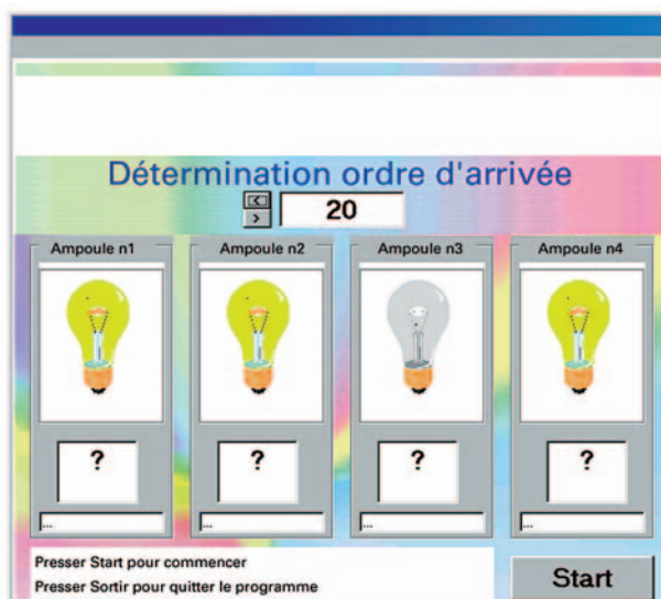
Figure 16: Ce logiciel très simple peut être utilisé pour établir lequel des quatre poussoirs est pressé en premier.
