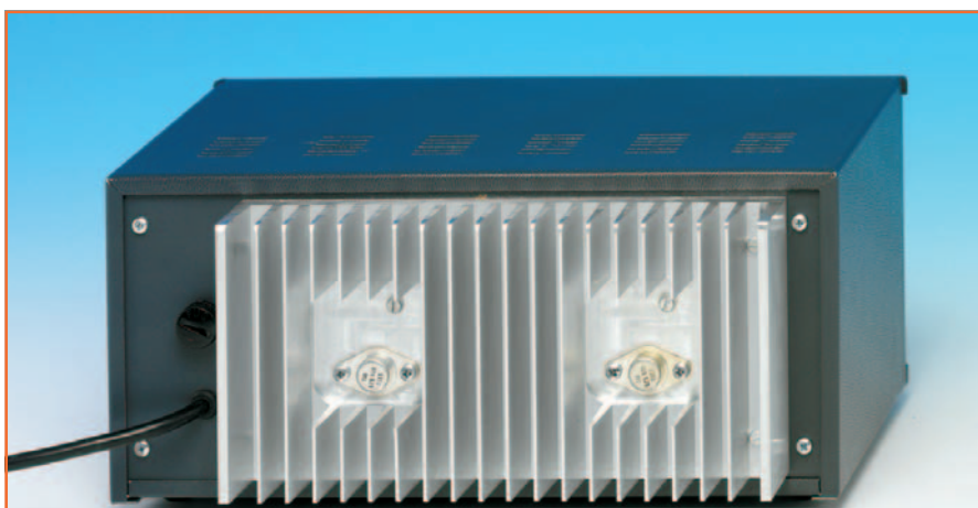
Figure 16: Le gros dissipateur à ailettes est lui-même fixé à l'extérieur du panneau arrière (préalablement découpé pour le passage de la platine EN1624) à l'aide de 4 boulons. On voit que les deux thyristors ont pris place dans les évidements fraisés entre les ailettes.
