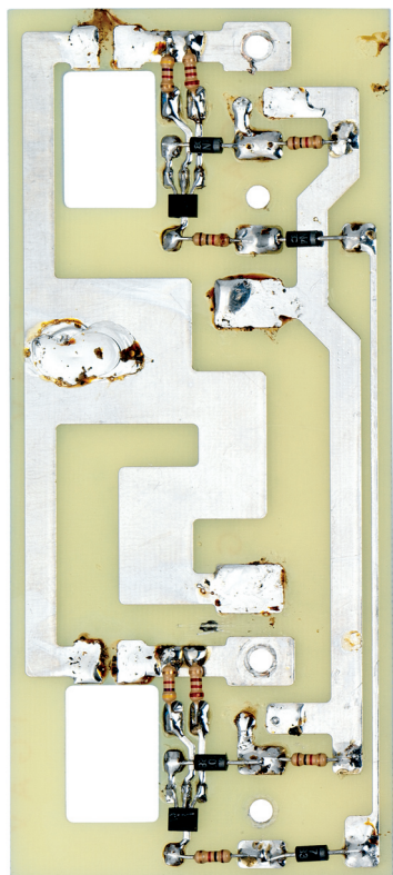
Figure 13: Photo d'un des prototypes de la platine de puissance EN1623/B. Les composants et les soudures sont du même côté (sauf pour les thyristors, voir figure 14). Les larges pistes doivent être généreusement étamées pour permettre le passage sans échauffement des forts courants: pour une bonne conductivité, les soudures doivent être claires.
