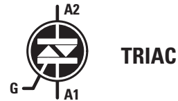
Figure 4 : Représentation schématique d'un triac. Sorties G gâchette, A2 anode 2 et A1 anode 1.
