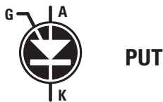
Figure 1: Représentation schématique du PUT. La gâchette est du côté de l'anode.
