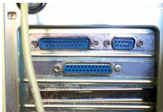
Figure 4: Sur certains PC plus anciens vous pouvez trouver un port série à 25 pôles, c'est le COM1 et un à 9 pôles DB9, le COM2.
