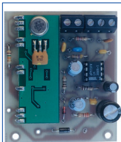
Figure 4c: Photo d'un des prototypes de la platine récepteur avec son module hybride en place.
