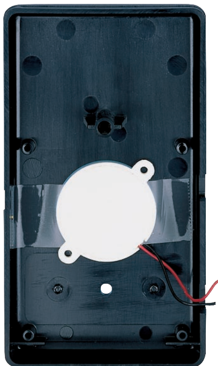
Figure 6: Le fond du boîtier plastique vu de l'intérieur. Le buzzer, à enfoncer dans le trou central de la face avant, est maintenu en place par un morceau de ruban adhésif ou deux gouttes de colle. Le petit trou reçoit la LED. Les quatre canons suffisent à fixer sans vis le petit circuit imprimé.
