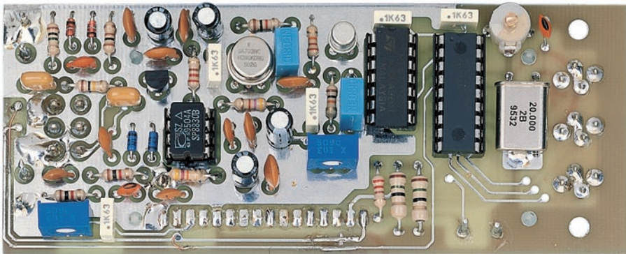
Figure 25: Photo d'un des prototypes de la platine EN1525. Les petits tétens métalliques repère-détrompeurs sortant de la base cylindrique du circuit intégré IC2 et du transistor TR1 sont à orienter vers le haut (voir aussi figure 24).
