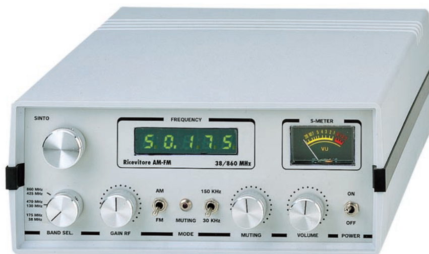
Figure 1: Le récepteur AM/FM à triple conversion de fréquence monté dans son boîtier avec fréquencemètre et S-mètre.
