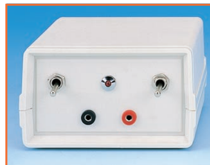
Figure 1: Voici notre "selfmètre HF" tout monté dans son boîtier plastique. Sur la photo de gauche, couplé à un fréquencemètre numérique, il est prêt à évaluer l'inductance d'une self connectée à ses douilles XL.
