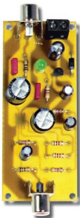
Figure 3 : Photo, vue de dessus de l'amplificateur vidéo, permettant de voir l'implantation des différents composants.
