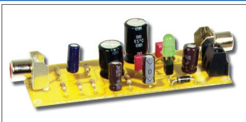
Figure 6 : Cette photo du montage terminé, permet de voir les prises RCA d'entrée et de sortie du signal vidéo ainsi que le sens de positionnement de la diode D1.
