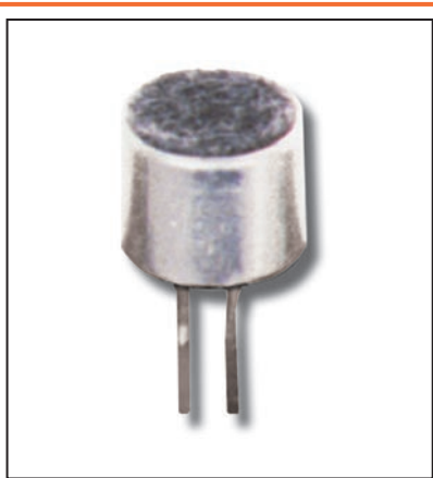
Figure 2 : Le micro électret à condensateur, bien que présentant deux seules pattes, incorpore un amplificateur à transistor à effet de champ qui lui confère une sensibilité telle qu'il arrive à capter même les chuchotements les plus faibles.
