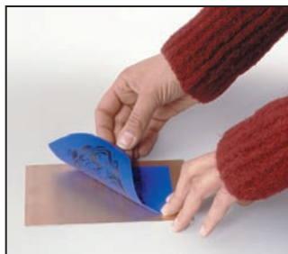
6 - Appuyez le papier PnP-blue de façon à ce que le toner soit en contact avec le cuivre du circuit.
