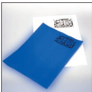
2 - Imprimez l'image du master sur le support, soit directement, soit via une photocopieuse.
