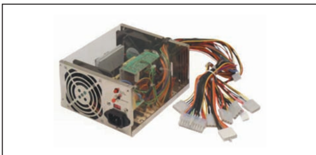
Figure 8 : Les alimentations ATX.
