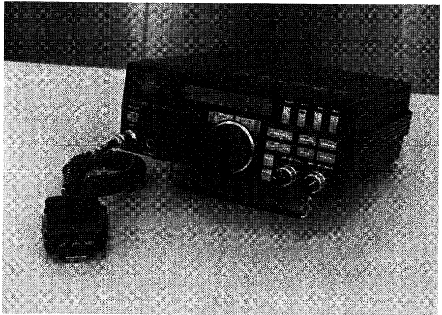
Foto 1 Afstemmen met de FT-747GX is ook mogelijk met de 'vuistmicrofoon' d.m.v. up/fast/down switches. (foto PA0JOZ)
