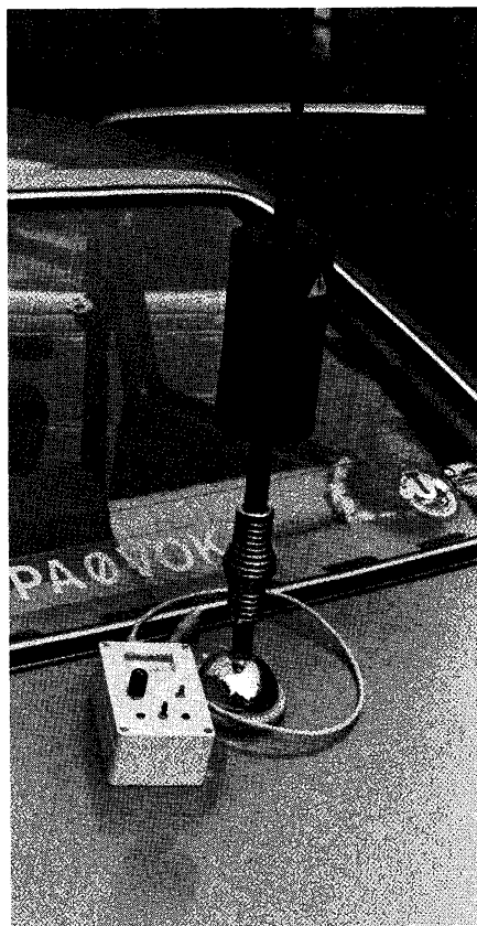
Foto 1. De antennevoet met spoel en bedieningskast.
