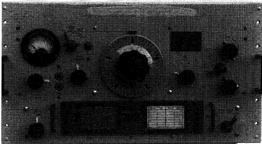
Fig. 8. HRO-ontvanger, in Australië nagemaakt door AWA. Het toestel werd door PA3CAV op een rommelmarkt gevonden en geheel in de oorspronkelijke staat teruggebracht.
