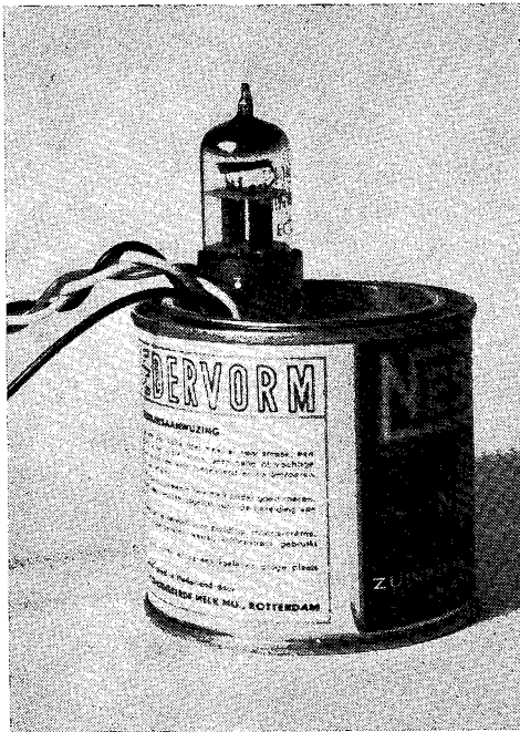
Uitvoering van amplinator in blikje. Alle onderdelen zijn goed afgeschermd, de buis zit bovenop gemonteerd
