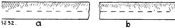
Fig. 1. Indien de opstelling van het kopje niet haaks is, is er verschil tussen de richting van magnetisering wanneer we de band na de opname keren ten opzichte van de spleetstand die ongewijzigd blijft. a = opname; magnetisering en spleetstand gelijk; b = weergave; magnetisering klopt niet meer met de spleetstand
