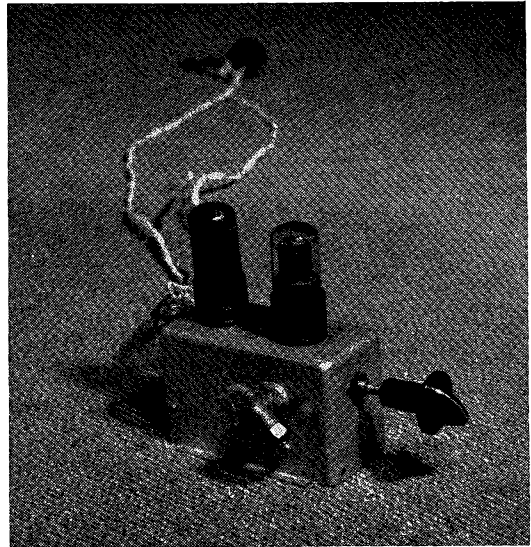
De versterker van PAoYF, voor allerlei doeleinden geschikt, is ondergebracht in een chassis van zeer kleine afmetingen. Men dient er op te letten, dat het ontwerp van Haagse oorsprong is en de netvoeding dus 127 V bedraagt. Aanraking van onder spanning staande delen kan gevaar opleveren (foto: PAoANI)
