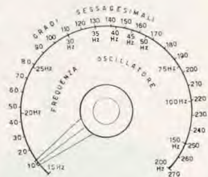
Figura 4 - Quadrante graduato in Hz, con scala di riferimento in gradi sessagesimali, utilizzabile con manopola a indice (schematizzato in figura). I potenziometri R_{1a} e R_{1b} devono essere inseriti per la loro massima resistenza quando la manopola a indice si trova all'inizio della scala (15 Hz).
