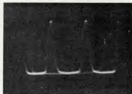
Impulsi a 1MHz visti tramite il « rise time improver ».
