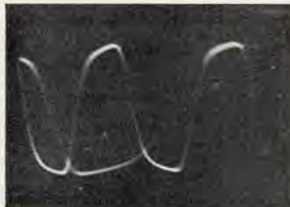
« Rise time improver »: onda quadra a 1MHz vista direttamente.
