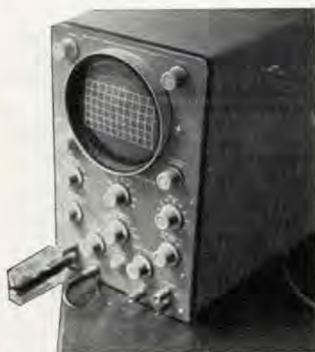
Il « rise time improver » innestato nell'oscilloscopio.
