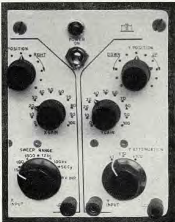
Particolare del pannello di oscilloscopio già visto più sopra; si rivela anche in dettaglio, l'accuratezza e la buona riuscita del lavoro.
