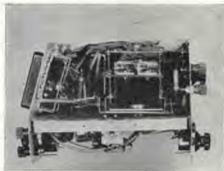
Lato destro; a sinistra si nota M1 e gli shunt; a destra, sopra il telaio, sono visibili, dal basso, T1 sul radiatore, D6/D9, sopra T1, montati su basetta di bachelite e provvisti di radiatori; sopra di essi c'è T4 su radiatore. In basso, a metà, si vede P2, montato su una squadretta di alluminio; a destra c'è P6.
