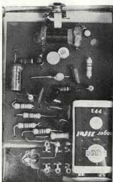
Interno del generatore di segnali F.M.
