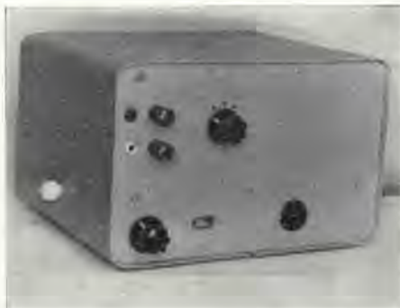
Retro; in alto, da sinistra, si notano le boccole d'uscita dell'alimentatore secondario, i morsetti d'uscita dell'alternata, la manopola di C5. Sotto, da sinistra, vi è la manopola di P6, la presa per il cavo di alimentazione e il cambiotensione-portafu- sibile.
