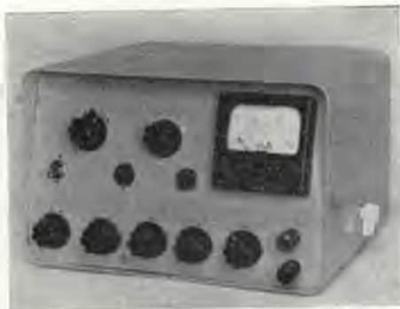
Frontale; da sinistra, in alto, vi sono le manopole di C2 e C4 e lo strumento; a metà, allineati, si notano S1, S2 e L1; in basso, sempre verso destra, le manopole di C3, P3, P4, P5, P1 e i morsetti d'uscita in c.c.
