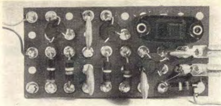
Fotografia «in pianta» del prototipo realizzato nel nostro laboratorio: attiriamo l'attenzione del lettore sull'ordine e la «pulizia di cablaggio» che è possibile conseguire operando con calma e studiando la disposizione delle parti accuratamente.
