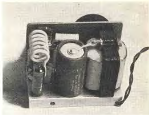
Interno del ricevitore: si noti la sproporzione fra l'ingombro delle parti relative all'alimentazione (trasformatore, condensatori) e quelle del Ricevitore vero e proprio (valvola, condensatore variabile, bobina, ecc.).
