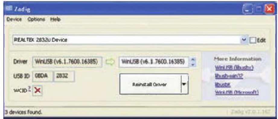
Figura 2. El instalador de drivers Zadig para Windows XP. El driver WinUSB es absolutamente esencial para que el SDR# reconozca el dongle RTL2832 y para mí fue la parte más difícil hasta conseguir finalmente que funcionara todo satisfactoriamente. Comprueba que instalas el driver WinUSB para el USB Dongle RTL2832 y no para cualquier otro dispositivo. Comprueba bien la identificación del dispositivo al que se lo cambiarás, como explico en el texto.
