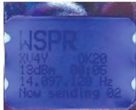
Foto A: Pantalla de la baliza WSPR del autor transmitiendo una señal para el Weak Signal Propagation Reporter.
