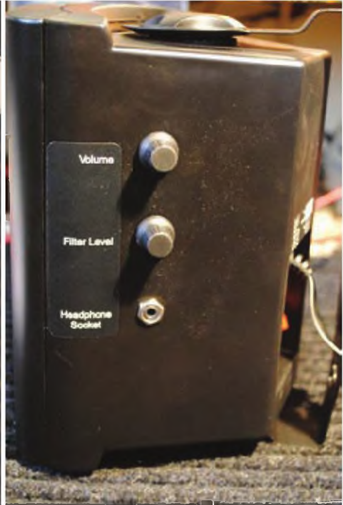
Foto C: Lateral del altavoz, mostrando los controles de volumen y de nivel de procesado, junto con el conector para auriculares, para aprovechar los beneficios del procesado DSP cuando utilizas auriculares.
