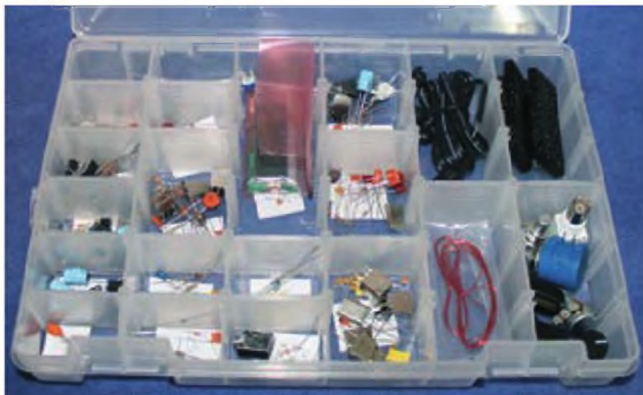
Foto A: Bandeja para la clasificación de componentes con casillas removibles.
