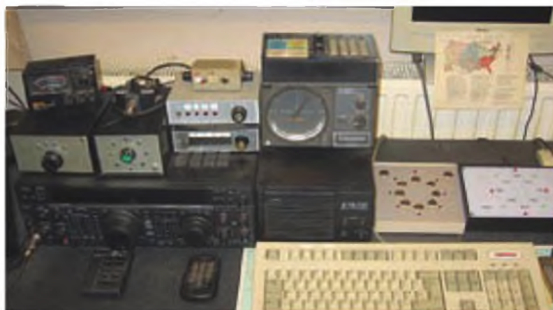
Foto C. Vista de las diferentes cajas de conmutación. En el centro y encima del equipo FT-1000MP se encuentra el antiguo conmutador. A la izquierda de este se encuentra la caja de control K9AY. A la derecha del altavoz se encuentra la primera caja de mando con pulsadores y a continuación la de pulsadores de contacto.
