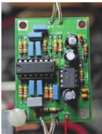
Foto C. El filtro Hi-Per-Mite montado.
