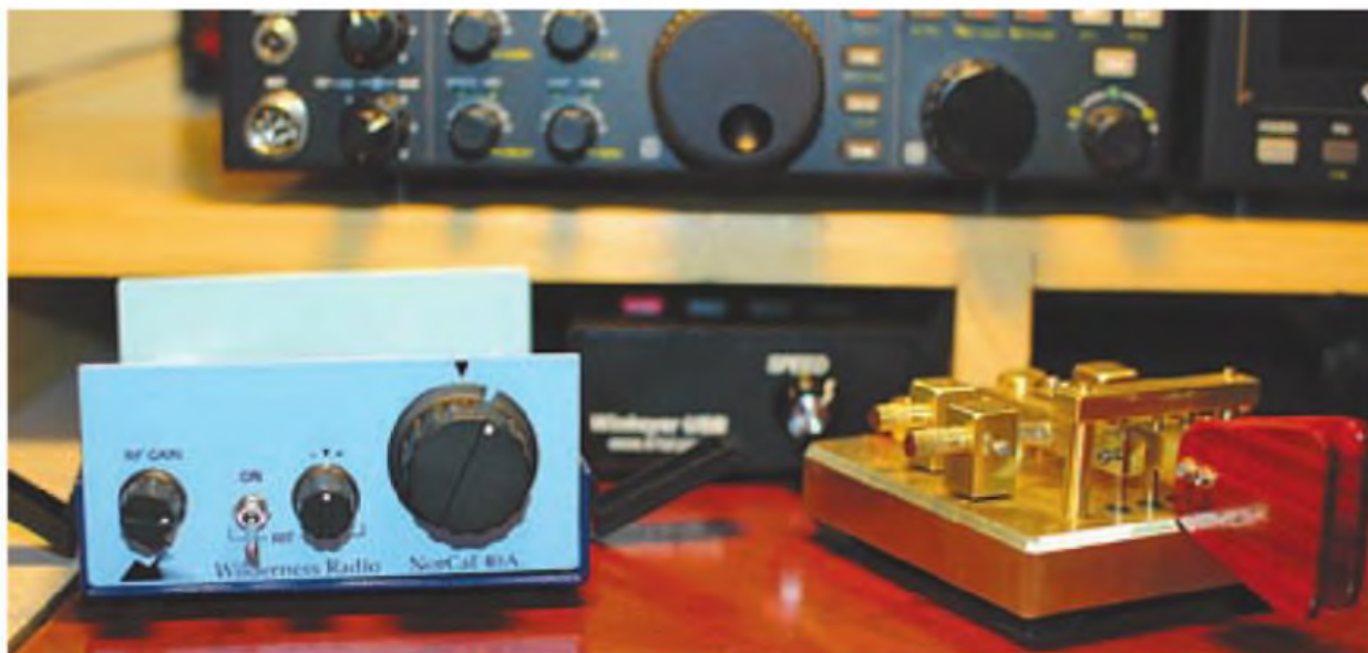
Foto E. El kit del NC-40A finalizado, listo para realizar algunos contactos QRP. Es el momento más emocionante de la puesta en marcha. Afortunadamente, funcionó a la primera.
