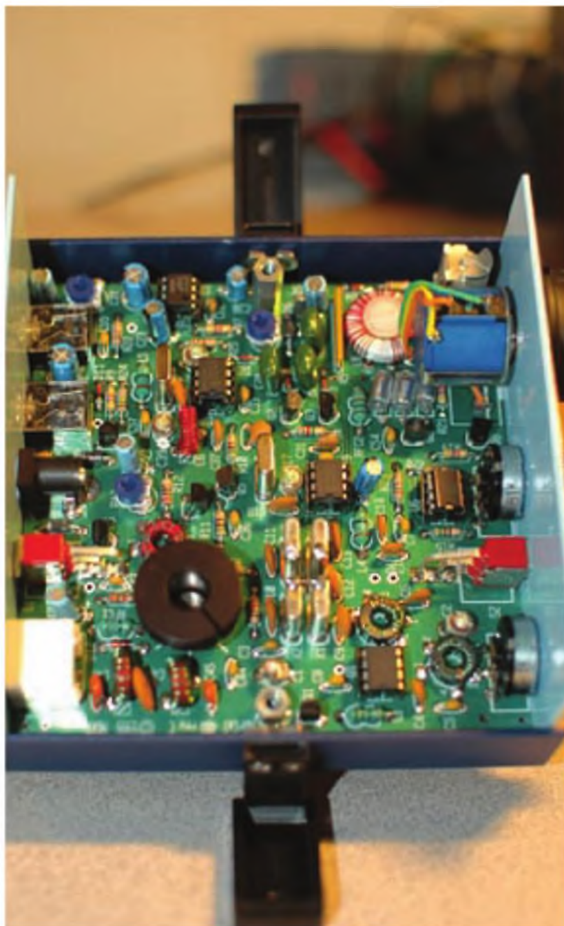
Foto D. Una vista superior de la placa de circuito impreso montada antes de dar por terminado el montaje y colocarle la tapa superior. Arriba a la derecha se observa el potenciómetro de cinco vueltas que permite ajustar con precisión la frecuencia de emisión y recepción.
