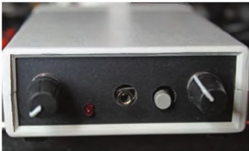
Foto B. Panel frontal del CW Scrubber. Se observan los controles y el conector de salida de audio.
