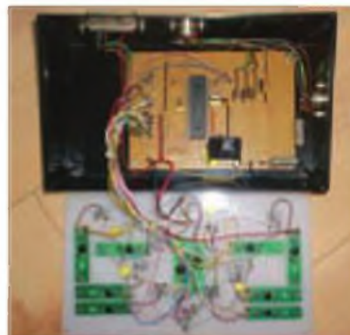
Foto B. El interior de la nueva caja de pulsadores de control. Se observan los circuitos impresos de los pulsadores de contacto (ver texto).
