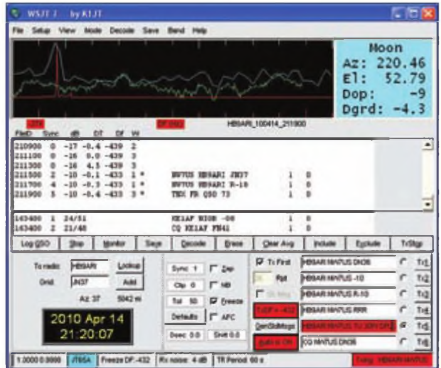
Figura 1. Captación de una pantalla, mostrando el software WSJT de Joe Taylor, K1JT en el protocolo de comunicaciones digitales en modo JT65A en la frecuencia de 14.076 MHz, USB. NW7US acaba de hacer un QSO exitoso con HB9ARI. (Fuente: NW7US, usando WSJT)
