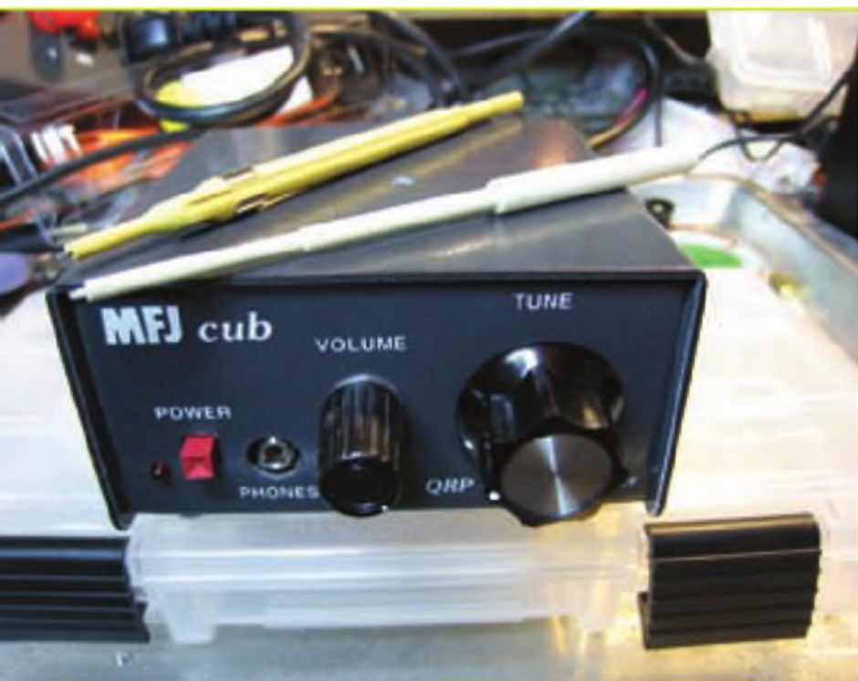
Foto D. El kit completo en su caja y las herramientas de sintonía necesarias para el ajuste.
