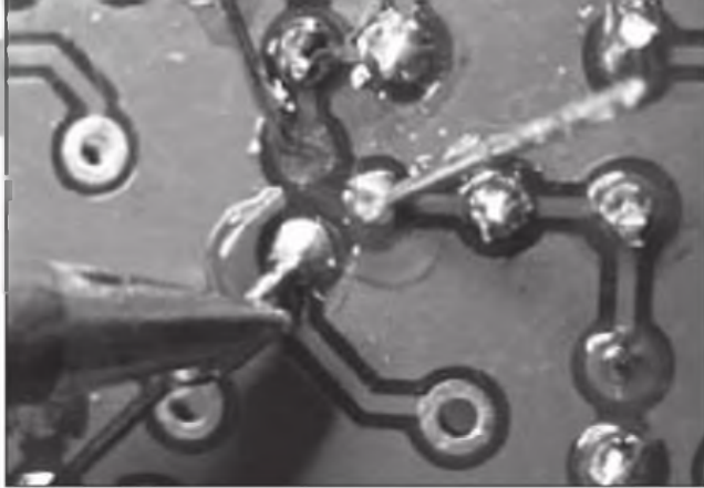
Foto B. Retirar la soldadura sobrante de la conexión con la punta del soldador y arrastrándola a lo largo de la patilla dejará una soldadura casi perfecta.
