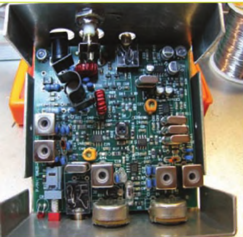
Foto E. La placa ya montada en su caja. Observa el conector BNC colocado encima del conector RCA.
