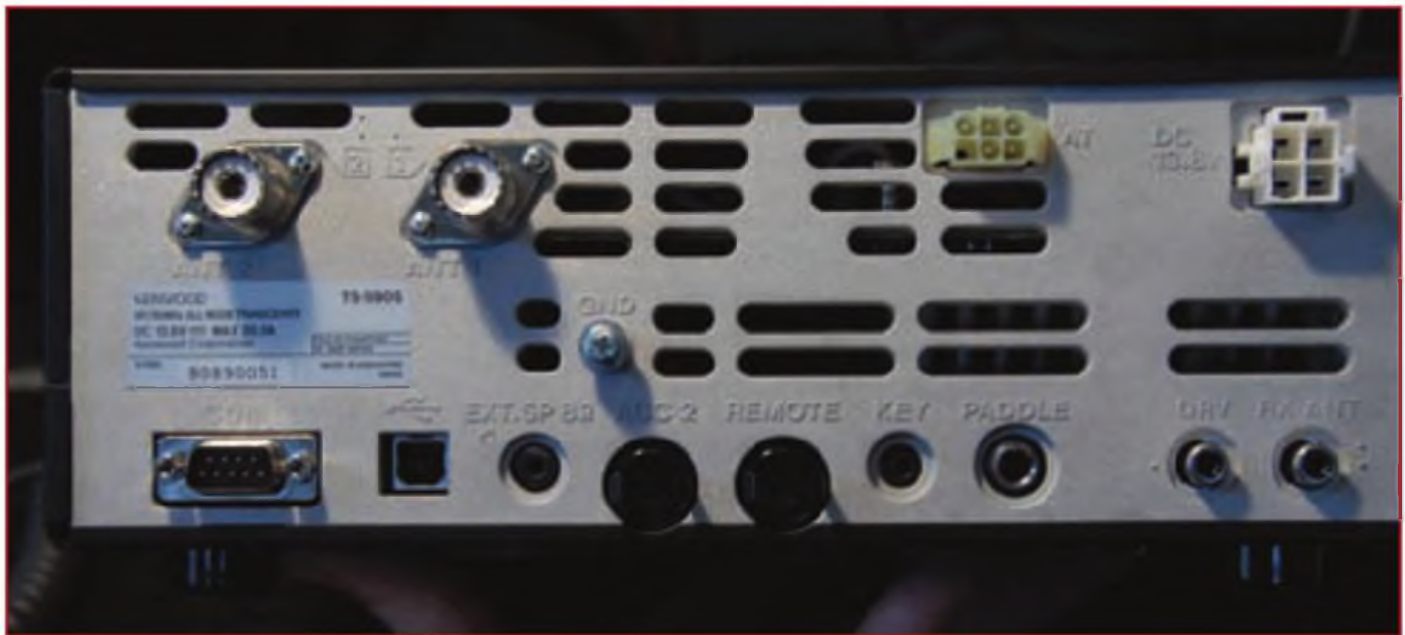
Figura 2. Panel posterior del TS-590. Obsérvese que dispone tanto de un puerto serie DB-9 como de un USB para la conexión con ordenadores o periféricos.
