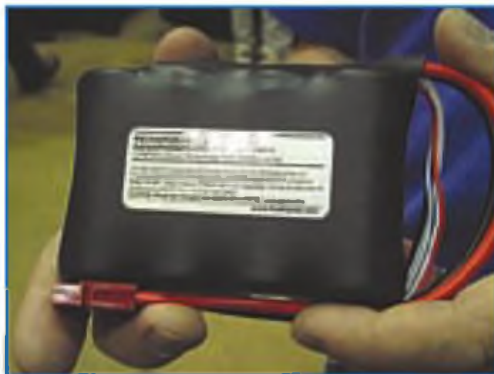
Foto F. Moviéndose entre antenas portátiles, Buddipole presentó este año una batería de alta capacidad en nanofosfato de ión-litio para operaciones de larga duración.
