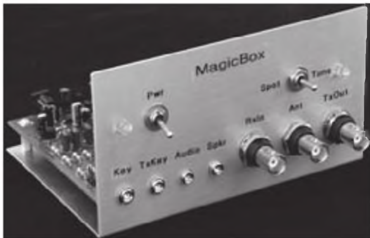
Foto D. La caja mágica MagicBox de Jim Kortge, K8IQY, hace el trabajo duro cuando se trata de interconectar un transmisor y un receptor separados.
