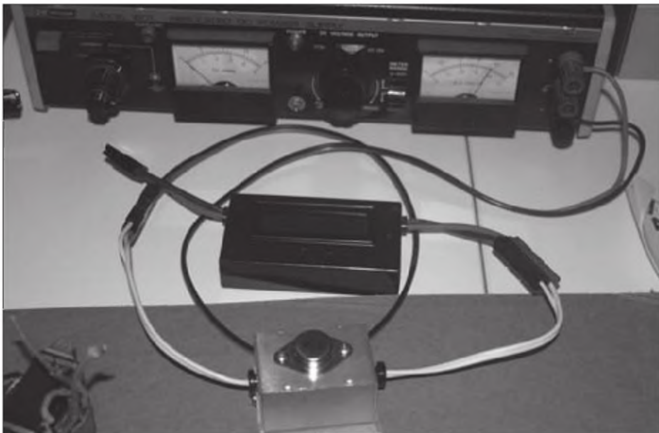
Foto E. Ésta es la caja de prevención de sobretensiones. La uso siempre que quiero asegurarme que cualquier equipo alimentado con mi fuente de 48V recibirá 12V como máximo.
