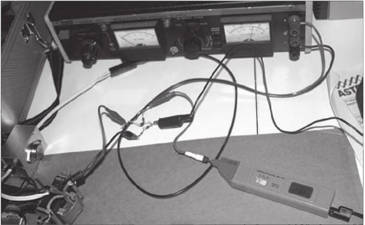
Foto D. He aquí el "corrector de polaridad" en su estado de prototipo, usando diodos pequeños. Cualquier polaridad aplicada a la entrada se aplica correctamente a la salida.
