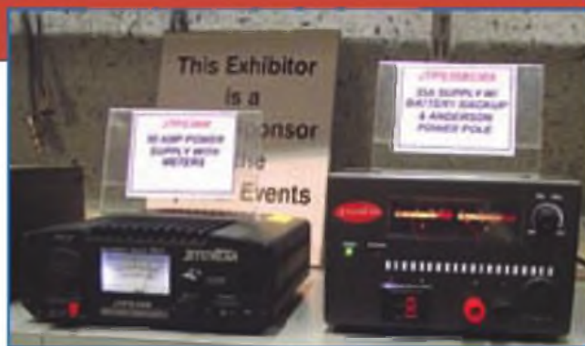
Foto A. Dos de las nuevas fuentes Jetstream, la de 30 A JTPS30M y la de 35 A JTPS35BCMA.
