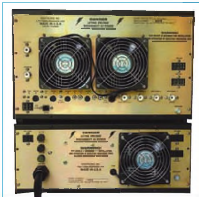
Foto B. Vista posterior del DX-2400L1. Obsérvense las dos entradas de RF (izquierda), para dos radios y las cuatro salidas de antena, en la parte inferior, seleccionables mediante un conmutador incorporado.
