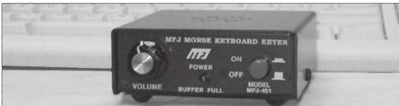
Foto B. Uno de los teclados especiales para CW del mercado actual es el MFJ-451, que se vende con o sin teclado (para quienes desean aprovechar un teclado de ordenador). (Foto cortesía de MFJ Enterprises)
