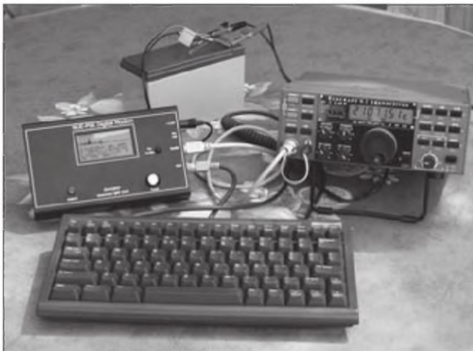
Foto F. El módem digital NUE-PSK conectado a un teclado, un transceptor K2 y a una batería que lo convierten en una estación digital portátil muy compacta.
