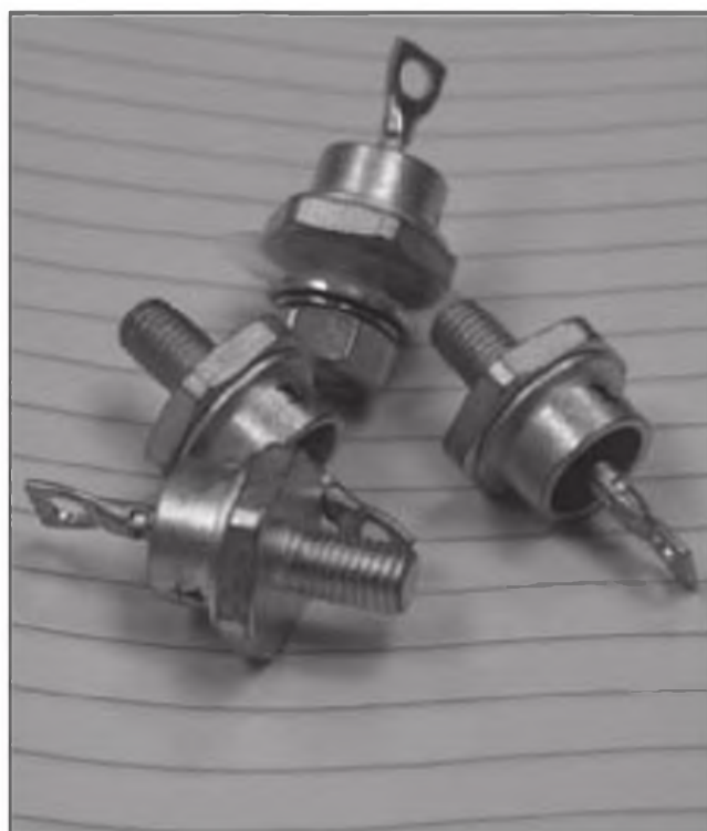
Foto C. Los diodos rectificadores para montaje en disipador son perfectos para este tipo de circuitos de protección porque normalmente soportan corrientes elevadas.
