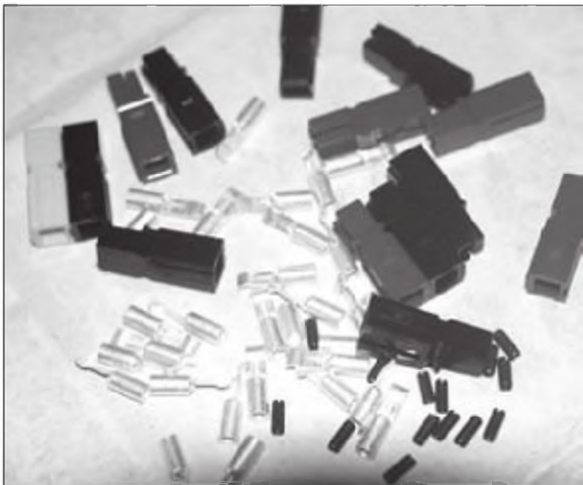
Foto A. El conector PowerPole para 30 A de Anderson se está convirtiendo en el más popular entre la radioafición y los grupos de protección civil. Es un conector de plástico que viene en varias configuraciones y capacidades de corriente. Hay también un conector compatible fabricado por AMP.
