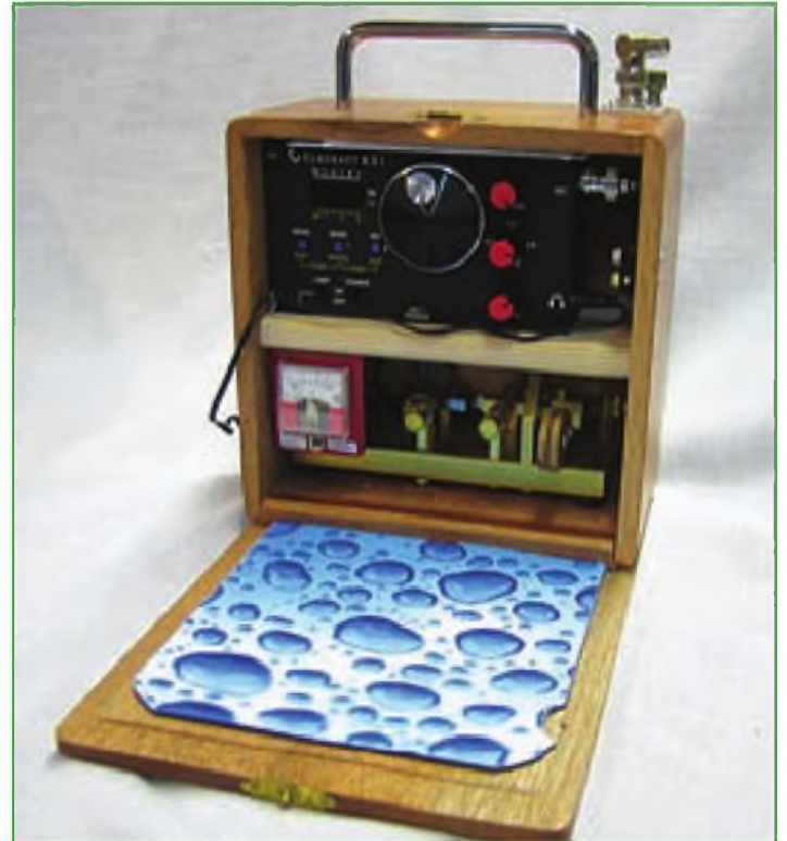
Foto A. Esta estación QRP completa en una caja montada por Bob Zimmer, NV1X, merece que la mires dos veces. Consiste en un transceptor Elecraft KX-1, equipado con botones de mando nuevos, una batería de 12 A y 1,2 A-h, un manipulador K4VIZ en el ángulo inferior derecho y un medidor de tensión de la batería, todo colocado en una caja de puros. ¡Fantástico! (fotos A y B cedidas pro NV1X).
