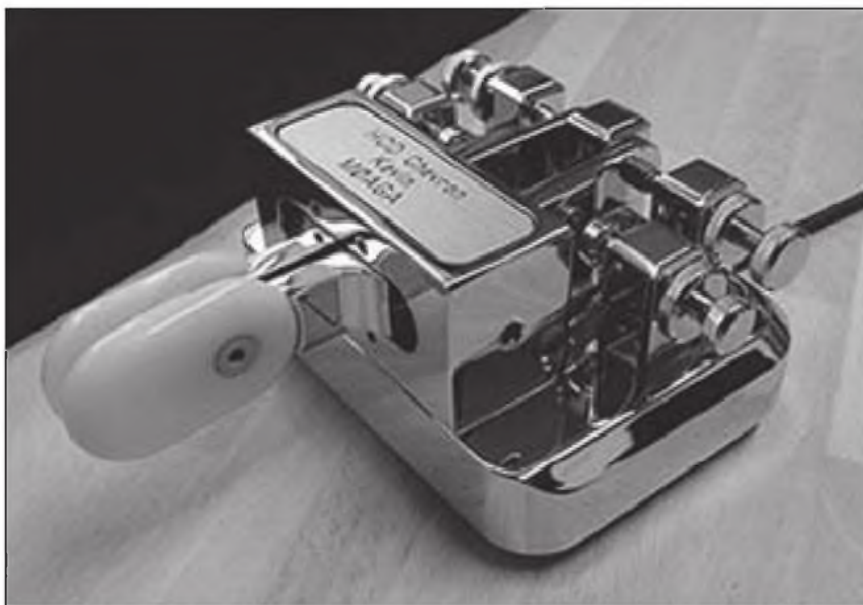
Foto B. El Rolls Royce de los manipuladores británicos, el Chevron, fabricado a mano por encargo (véase el texto para más detalles).
