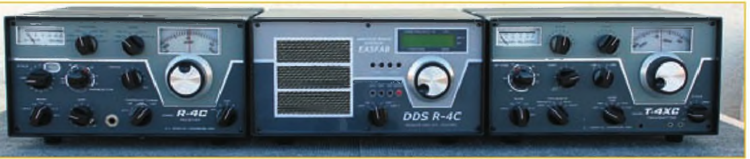
Una línea 4 de Drake completa, restaurada, modificada y complementada con un DDS R-4C.
