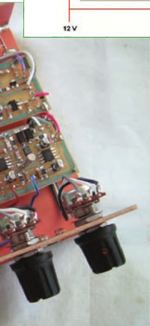
Foto G. Una vista más detallada de los cuatro módulos que completan el transceptor W5SUI nos revelan que está compuesto por un transmisor Tuna-Tin 2 , un receptor MRX modificado, un manipulador Jackson Harbor y una placa de conmutación T/R similar a las utilizadas en el kit Tuna Tooper que proporciona < www.qrpme.com >. Chuck también ha grabado sus propias placas.
