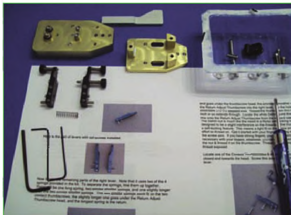
Foto D. Veinte o treinta minutos más tarde, el manipulador Bushwhacker está ya medio montado. El mecanismo (todas esas partes sueltas que ves) quedará protegido por un marco de aluminio anodizado y dorado. La pala es de aproximadamente 18 x 18 mm, y queda más o menos centrada a 2,5 cm por encima de la mesa, cuando se monta sobre la base opcional de 12 mm.
