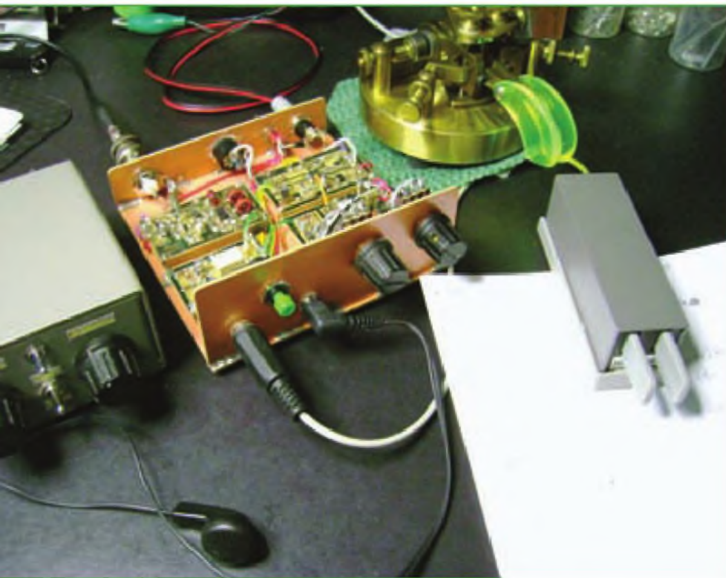
Foto H. El transceptor SMD de W5SUJ operando en 40 metros. El mini-equipa opera complementado por un acoplador de antena BLT de <qrpkits.com> (a la izquierda) manejado con un manipulador R3A sobre una base redonda de J.M. March, K4QU (ver <www.qsl.net/k4ku>); y otro de Palm Radio en el lado inferior derecho de MorseX.com.
