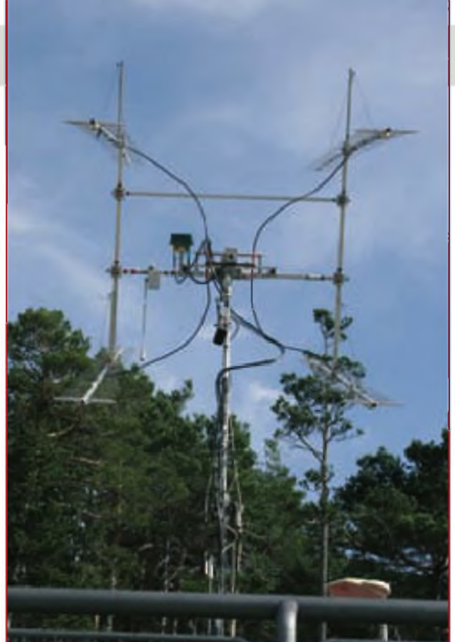
Foto 4. El sistema de antenas para 70 cm, listo y apuntando hacia la Luna (invisible a plena luz diurna).
