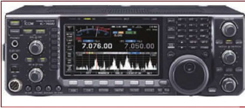
Foto I. El nuevo IC-7600 de ICOM es un transceptor todo modo de altas prestaciones para HF/50 MHz.
