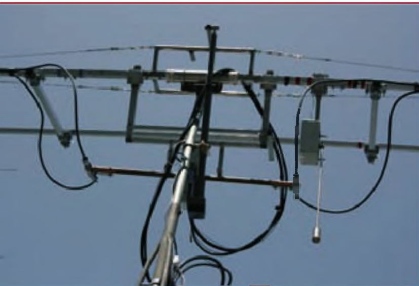
Foto 3. Vista en detalle del sistema de enfasado de las 4 antenas de 144 MHz y el péndulo indicador de elevación.
