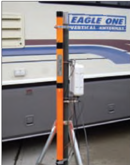
Foto D . La antena vertical Eagle One en posición replegada, con las bridas de montaje, el trípode opcional, y un adaptador de antena (a cargo del usuario). Completamente extendida mide 9,3 metros de alto, y plegada mide 1,12 metros, lo cual facilita su transporte.
