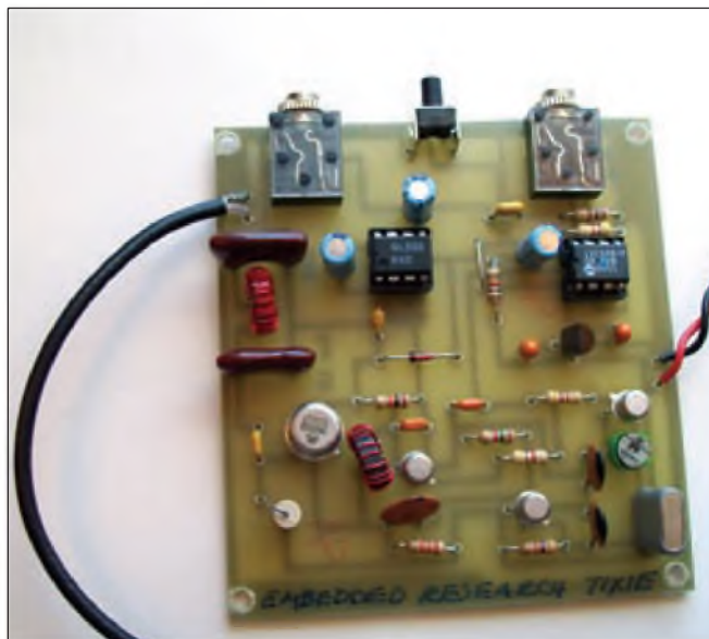
Foto D. El transceptor Pixie equipado por Embedded Research con un manipulador Tick y vendido como el transceptor Tixie hace unos pocos años. Existen versiones caseras montadas en placas o en el aire con miles de formas con y sin el IC del manipulador, pues continua siendo muy popular.
