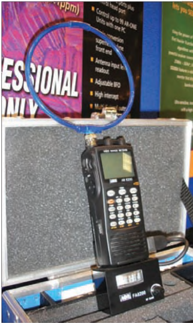
El FA-8200 de la casa AOR es un equipo especial para la caza del zorro preparado hasta para localizar balizas de emergencia de aviones.
