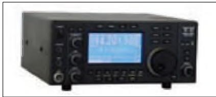
Foto A. El transceptor de HF Ten-Tec Jupiter 538: "todas las funciones principales al alcance de los dedos, mediante un control dedicado o mandos multifunción". Fotos cortesía de los respectivos suministradores, salvo indicación.
