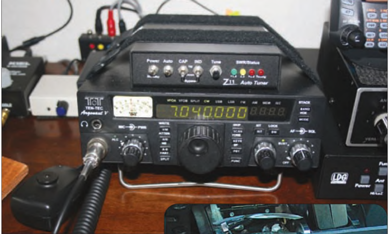
Foto B. La instalación casera de W4MQC muestra el popular transceptor Argonaut V con un acoplador LDG Z11 y algunos manipuladores de CW y micros, ¡excelente! (Foto cedida por 4MQC).
