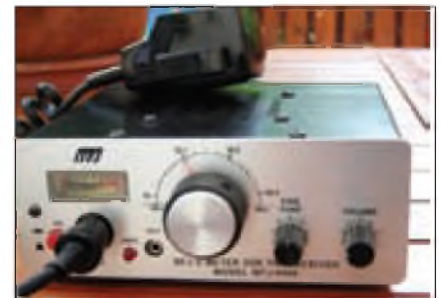
Foto C. Transceptor de SSB MFJ-9406 para la banda de 6 metros. (Foto de EA3DU).
