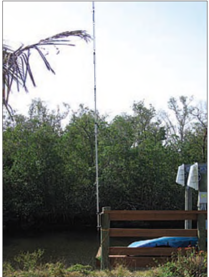
Foto A. Durante un reciente QSO en QRP con Alan, W4MQC, le pregunté por su equipo y antena y me envió esta foto. Alan utiliza una antena vertical Hustler 6BTV montada en la cubierta de su barco, amarrado detrás de su casa. Un solo radial conduce la contra-antena hacia el agua salada, que es muy conductora en el Golfo de México. Seguro que es un sistema de tierra muy efectivo.
