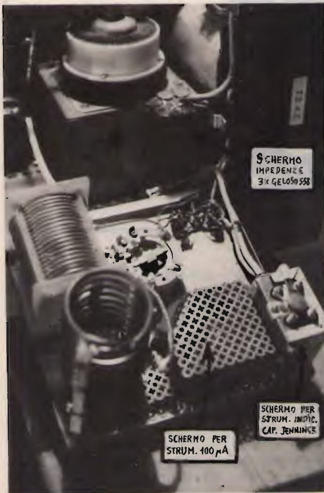
"Assemblaggio degli strumenti indicatori e dei relativi schermi".
