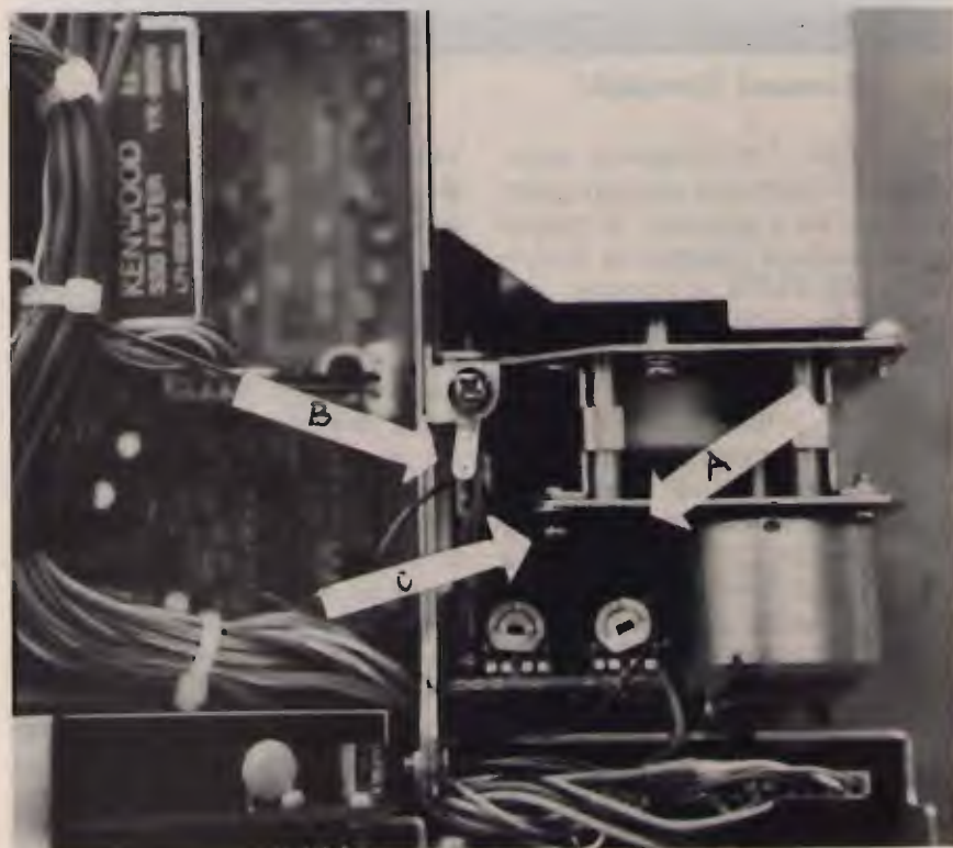
③ La freccia "A" indica il cicalino fissato alla piastra portamotorini. La freccia "B" indica il filo nero collegato a massa. La freccia "C" indica la vite sotto la quale potete fissare il cicalino.
