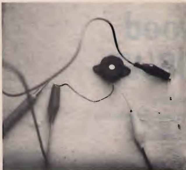
② Il cicalino che ho aggiunto e la soluzione ottimale con i due diodi prima della sistemazione finale.
