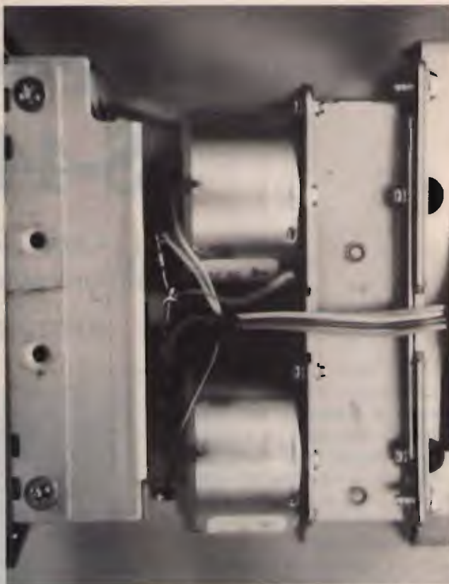
④ I due diodi aggiunti a modifica ultimata.
