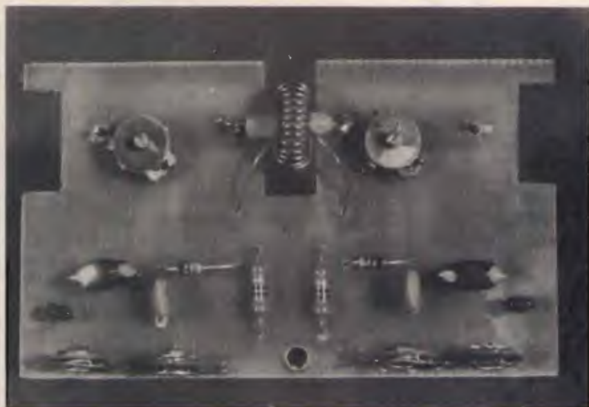
Un prototipo di laboratorio del ROSmetro-wattmetro, a montaggio ultimato.
