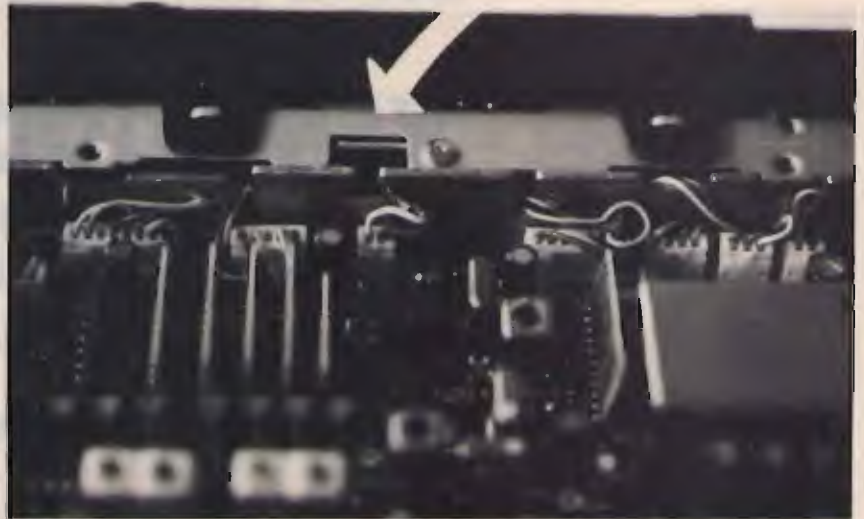
foto 2 La freccia indica il rettangolino entro il quale troverete la "R-25" o la "R-75".
