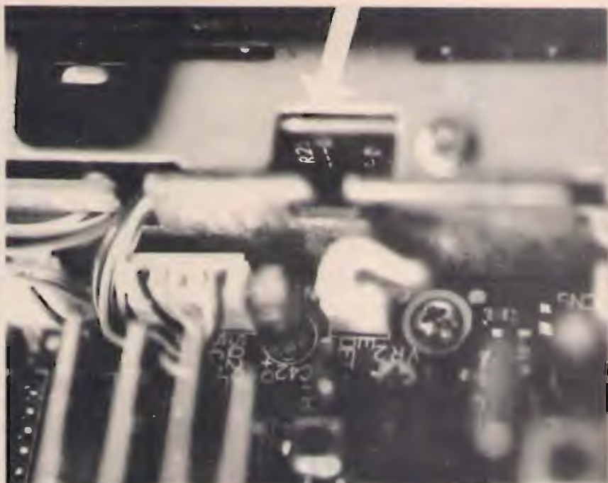
foto 3 La freccia indica l'esatta posizione di "R-25". Notare che la foto è stata scattata sul TM-731 E originalmente già esteso con la "R-25" serigrafata sul circuito e non fisicamente presente.
