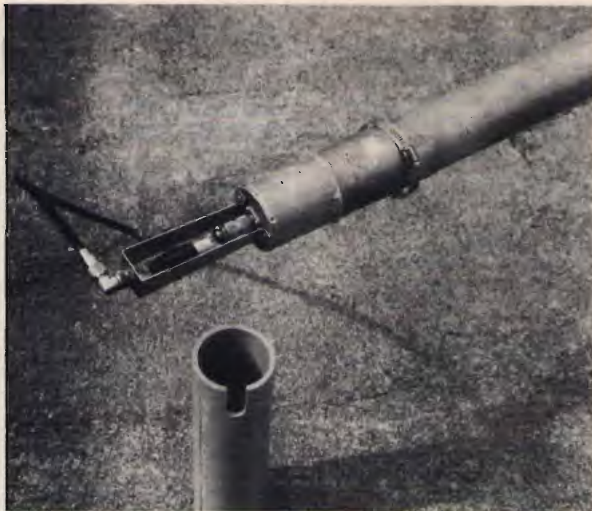
foto 3 Il trasformatore di impedenza alla base del palo coassiale.
