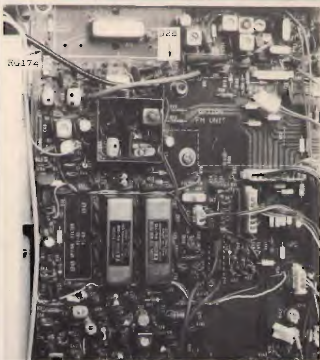
Ricevitore ICOM ICR 71 - PARTICOLARE INGRANDITO DELLO STADIO AMPLIFICATORE DI BASSA FREQUENZA e punti di collegamento del cavetto stereo.
