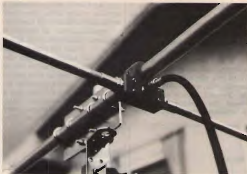
foto 2 Particolare del prototipo comprendente ancoraggio del cavo e piastra di sostegno (kit SIRTEL).
