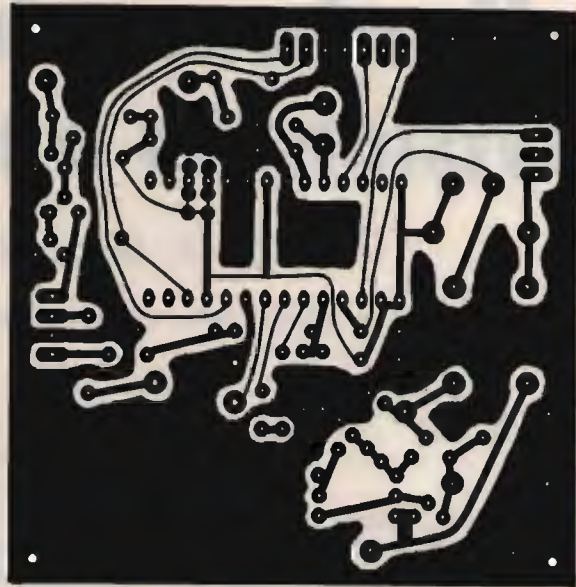
figura 3c Manchester modem, circuito stampato (lato rame).
