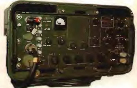
NATIONAL R1490 - Ricevitore 2-30 MHz stato solido, completo di filtro, notch, rete, 110 E 24 DC.
