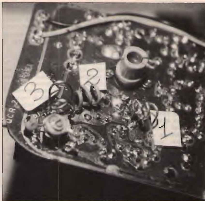
Vista delle bobine saldate dalla parte del circuito stampato.
