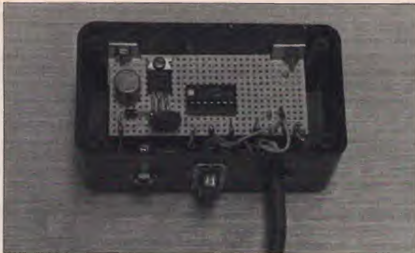
figura 4 Il prototipo dell'invertitore all'interno del suo contenitore plastico.
