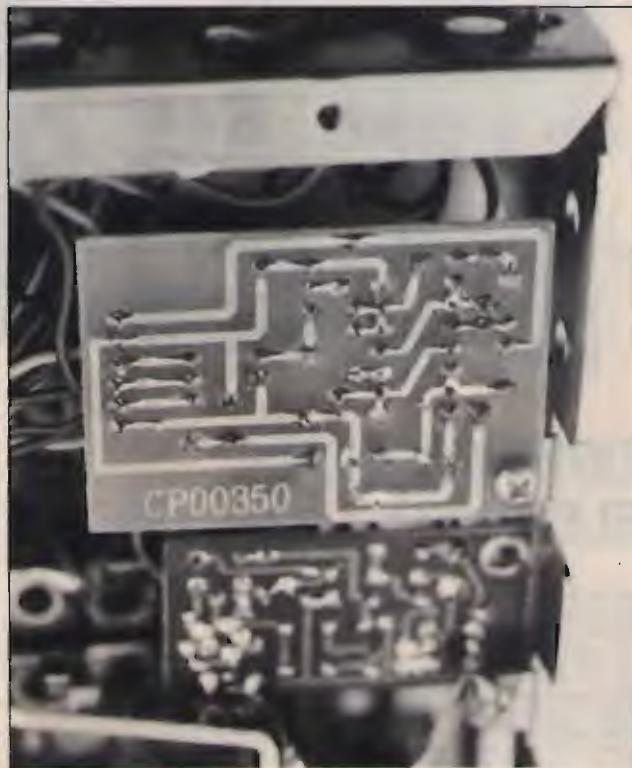
foto 2 La basetta del Roger-beep e quella della "modifica 120 canali, a bordo dell'Alan 48.
