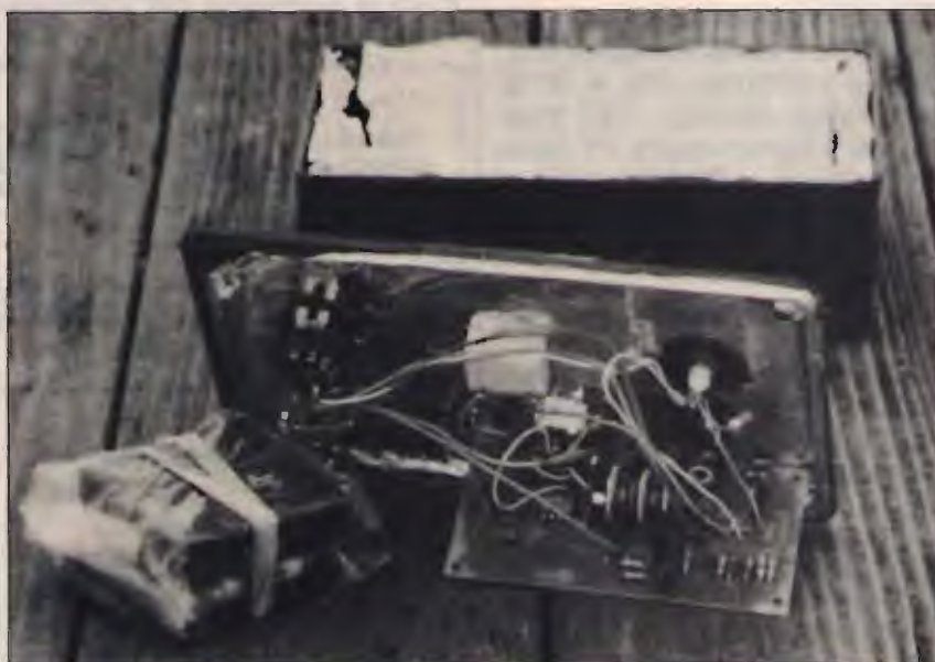
figura 8 Un prototipo dell'elettrometro a montaggio ultimato. Se il contenitore è in plastica, sarà necessario rivestirlo con pellicola d'alluminio.
