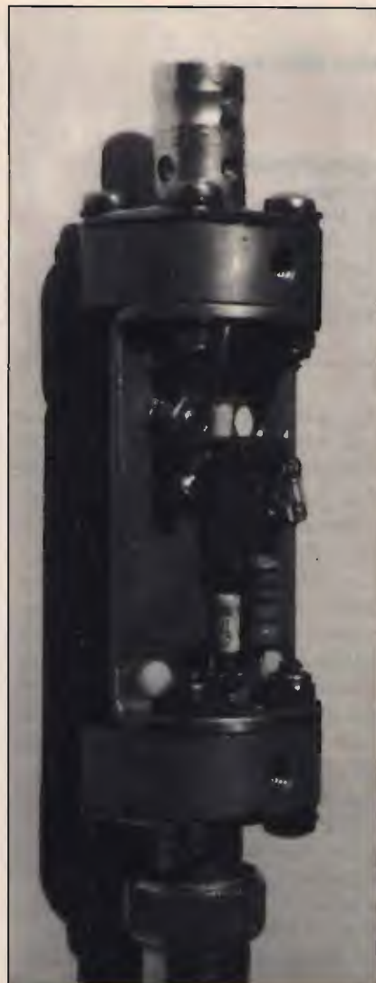
foto 3 Vista interna della sonda dal lato uscita e visualizzazione a Led della RF.
