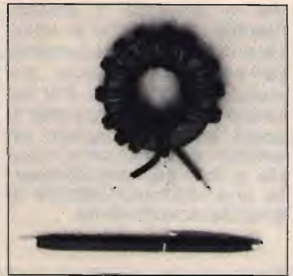
foto 3 Il trasformatore di bilanciamento fa uso di un toroide T-200.
