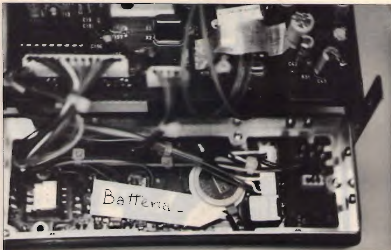
figura 3 La batteria al litio, che alimenta le memorie, è di immediata identificazione.
