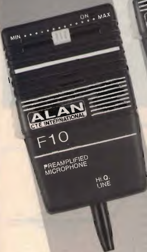
ALAN F10 - codice C239 Microfono preamplificato regolabile per apparati CB. Visible anche durante la guida notturna grazie ai particolari fosforescenti. Completo di connettore micro quattro. Alimentazione tramite batteria da 9 V.
