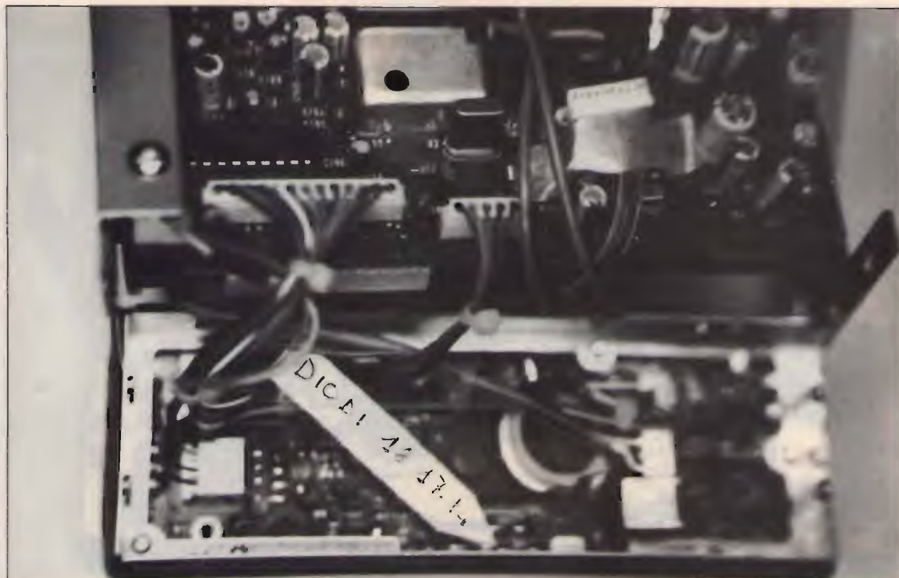
figura 5 I diodi 14, 17 e 18, indicati dalla freccia, debbono essere eliminati.
