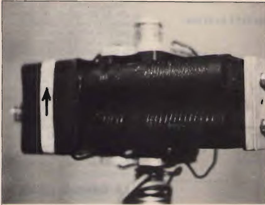
figura 2 Antenna ferrite accordata con una sola bobina. Quella mostrata in figura è stata poi denominata "antironzio" per le proprietà che mostra spesso di eliminare il ronzio di ricezione. Notare il senso dell'avvolgimento, indicato dalla freccia, che è contrario a quello della ferrite.
