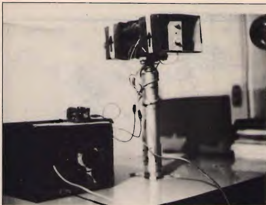
figura 4 Antenna ferrite accordata con le due bobine, durante la lunga fase di sperimentazione. È stato questo uno dei rari momenti durante i quali ho fatto ricezione sotto i 10 kHz, non dovuto tanto alla mancanza di Emittenti, quanto alla difficoltà di sintonizzare di volta in volta l'antenna ogni volta che cambiavo frequenza.
