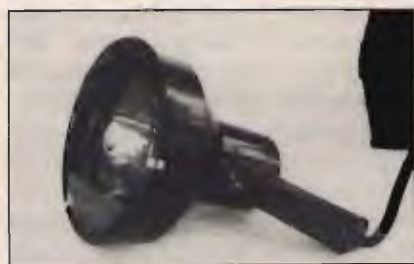
foto 5 La lampada Grimes per segnalazioni aeronautiche è dotata di traggardi e grilletto per la produzione di segnali Morse luminosi.
