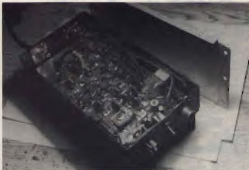
foto 6 Particolari di cablaggio del lineare: pannello di chiusura, collegamenti volanti, ecc.
