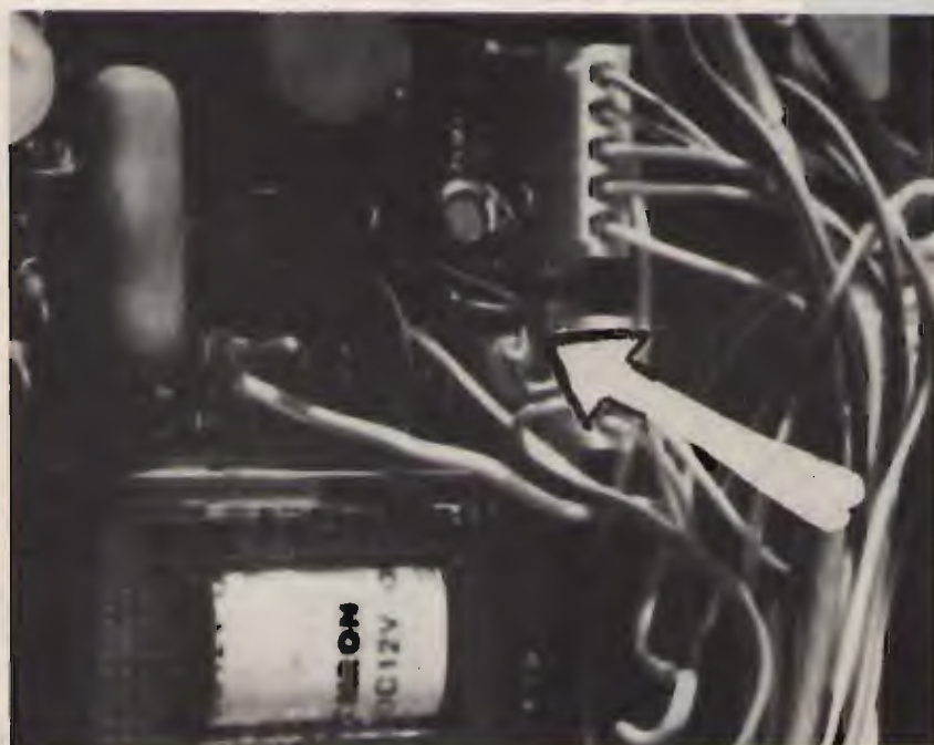
foto 8 La freccia indica R99 per la modifica dell'ALC.
