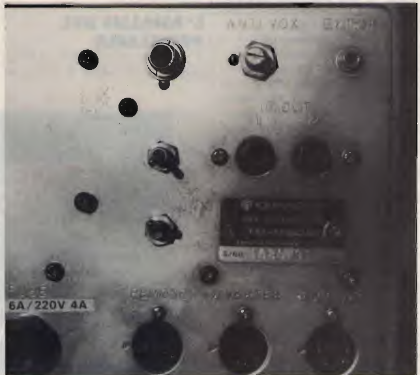
foto 2 I due deviatori messi posteriormente nei buchi già predisposti.
