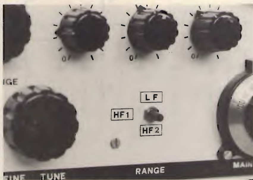
Particolare dell'unico comando selettore di gamma in sostituzione dei due precedentemente impiegati.
