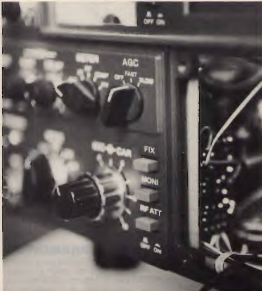
foto 6 Il telaino dove si attiva il FIX, dopo aver asportato il VFO.
