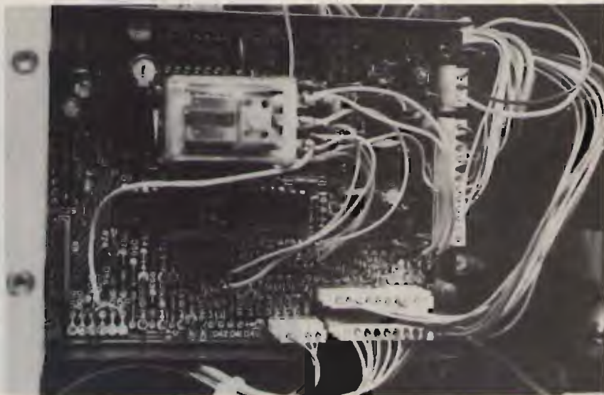
foto 3 La scheda Counter Unit dove si fa la modifica.
