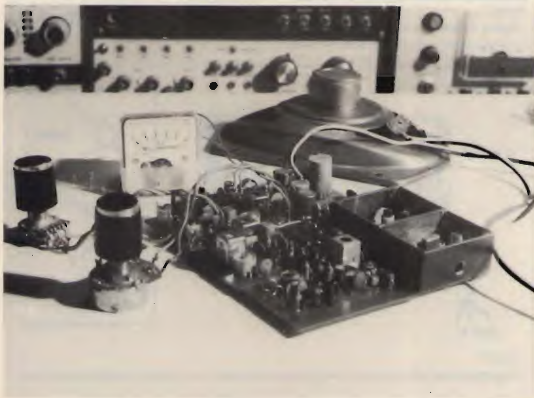
Foto d'insieme del ricevitore; si noti il foro praticato sulla lastrina di vetronite che funge da schermo al modulo n. 2 e che serve per la regolazione di P_1 .
